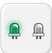
**B5** ИНДИКАТОР ВЫКЛЮЧЕН: МОДУЛЬ НЕ ПОЛУЧАЕТ СИГНАЛ АКТИВАЦИИ ОТ ВНЕШНЕГО УСТРОЙСТВА.
