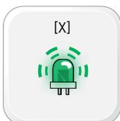
ДЛЯ ПЕРЕКЛЮЧЕНИЯ В РЕЖИМ УПРАВЛЕНИЯ "**ПО АНАЛОГУ**" (**HARDWIRED**), КОРОТКИМ ОДНОКРАТНЫМ НАЖАТИЕМ КНОПКИ ПРОГРАММИРОВАНИЯ ПЕРЕКЛЮЧИТЕ МОДУЛЬ В ЭТОТ РЕЖИМ. ИНДИКАТОР БУДЕТ МИГАТЬ **ДВОЙНЫМИ** ВСПЫШКАМИ ЗЕЛЕНОГО ЦВЕТА. ОДНОКРАТНЫМИ НАЖАТИЯМИ МОЖНО ПЕРЕКЛЮЧАТЬ РЕЖИМЫ IDL->HWD->IDL ДО ПОДТВЕРЖДЕНИЯ РЕЖИМА.
