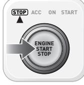
НАЖМИТЕ НА КНОПКУ "СТАРТ" ОДИН РАЗ ДО ПОЛОЖЕНИЯ OFF (ДЛЯ АВТОМОБИЛЕЙ С КНОПКОЙ "СТАРТ")
