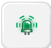
ПРИ ИСПОЛЬЗОВАНИИ ПРОШИВКИ SCA(ALL)-XX-IDL ПРИ ПОДАЧЕ ПИТАНИЯ НА МОДУЛЬ, ИНДИКАТОР МИГАЕТ **ОДНОКРАТНЫМИ** ВСПЫШКАМИ ЗЕЛЕННОГО ЦВЕТА, ЧТО ПОДТВЕРЖАЕТ, ЧТО МОДУЛЬ ЗАПРОГРАММИРОВАН ДЛЯ ЗАПУСКА ОТ ДОПОЛНИТЕЛЬНОЙ СИГНАЛИЗАЦИИ С УПРАВЛЕНИЕМ ПО ЦИФРОВОМУ ПРОТОКОЛУ **"2-WAY DATA"**
